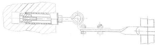
*Схема крепления лесов к стене*
